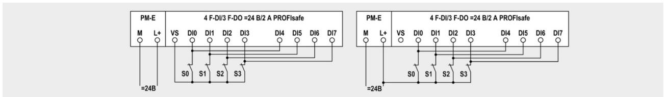
Схема 1.1: подключение 1-канальных датчиков
