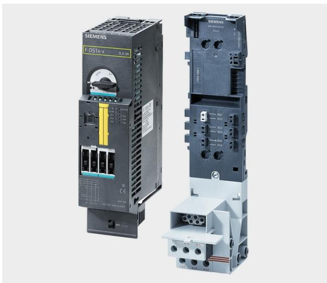
Модули фидеров нагрузки F-DS1e-x и F-RS1e-x выпускаются в пластиковых корпусах шириной 65 мм и 130 мм соответственно. Они устанавливаются на терминальные модули TM-FDS65 и TM-FRS130, монтируемые на стандартную профильную шину DIN. Эти терминальные модули оснащены внутренней силовой шиной 3-фазного переменного тока с током нагрузки до 50 А, а также дополнительными элементами кодирования, позволяющими задавать номер группы отключения, в которой будет работать фидер нагрузки.
