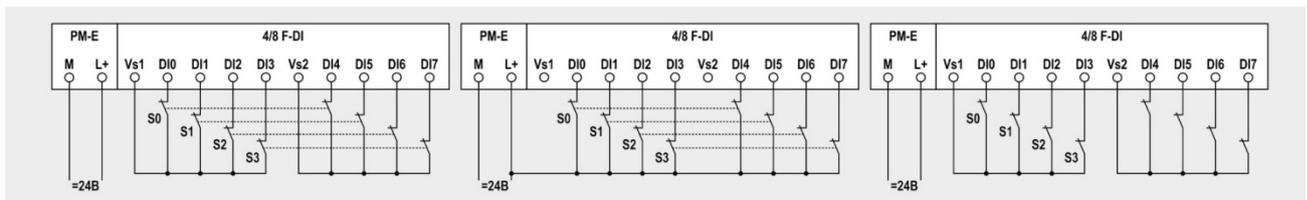
Схема 2.2: подключение 2-канальных датчиков и пар 1-канальных датчиков к 2-канальным входам
