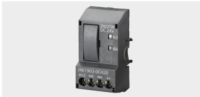
Силовые модули DS1e-x HF/ RS1e-x HF/ DSS1e-x HF/ F-DS1e-x/ F-RS1e-x могут комплектоваться модулем управления 2DI LC COM. Он устанавливается на специальное посадочное место на фронтальной панели фидера нагрузки и позволяет получать два дополнительных дискретных входа  $\approx 24$  В для непосредственного управления контактором.
