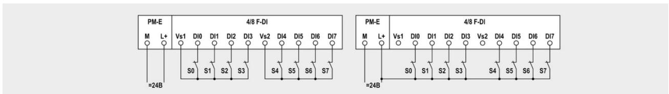
Схема 1: подключение 1-канальных датчиков к 1-канальным входам
