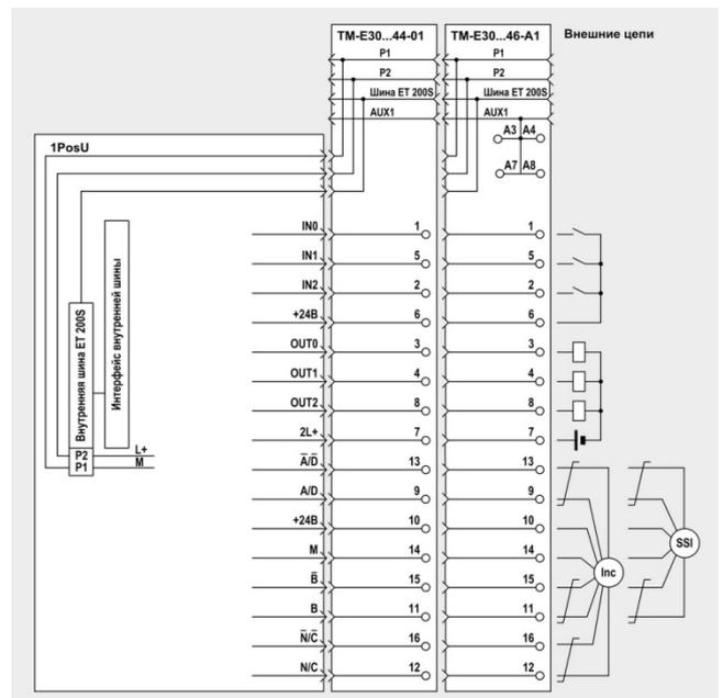
Встроенные дискретные выходы используются для формирования команд управления работой привода:
