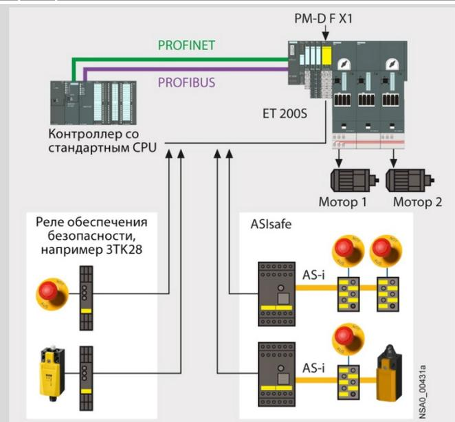
Система обеспечения безопасности на локальном уровне станции ET 200S с использованием фидеров нагрузки DS1e-x HF/ RS1e-x HF и внешних систем обеспечения безопасности.
