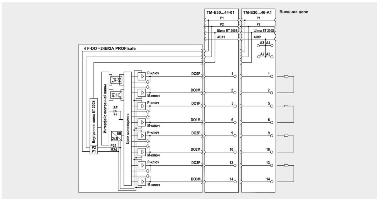
Модуль 4 F-DO DC24V/2A PROFIsafe выпускается в пластиковом корпусе шириной 30 мм и комплектуется этикеткой для маркировки внешних цепей желтого цвета. Он может устанавливаться на терминальные модули TM-E30S44-01, TM-E30C44-01, TM-E30S46-A1 или TM-E30C46-A1.
