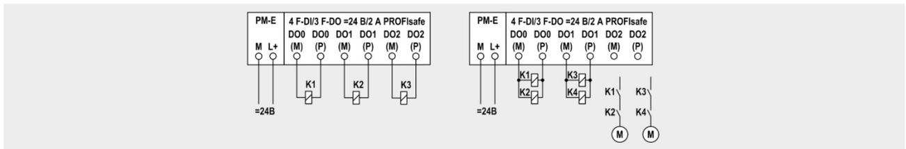
Схемы подключения нагрузки
