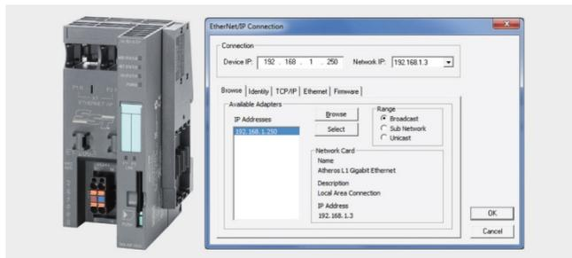
Модуль адаптера компании Molex (формально SST) для подключения станции ET 200S к сети Ethernet/IP и выполнения обмена данными с системой управления более высокого уровня (сканером). Он может использоваться с большинством модулей станции ET 200S, исключая модули PROFIsafe и силовые модули преобразователей частоты.
