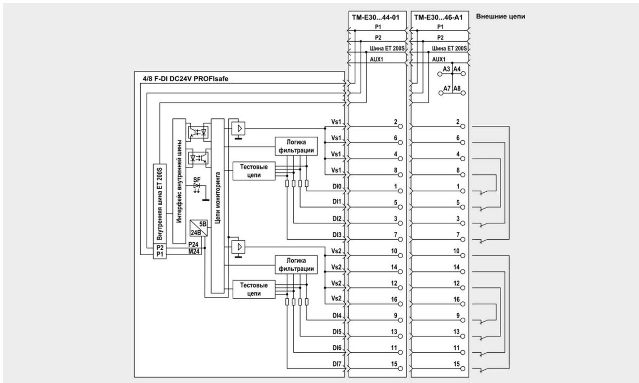
Модуль 4/8 F-DI DC24V PROFIsafe выпускается в пластиковом корпусе шириной 30 мм и комплектуется этикеткой для маркировки внешних цепей желтого цвета. Он может устанавливаться на терминальные модули TM-E30S44-01, TM-E30C44-01, TM-E30S46-A1 или TM-E30C46-A1.
