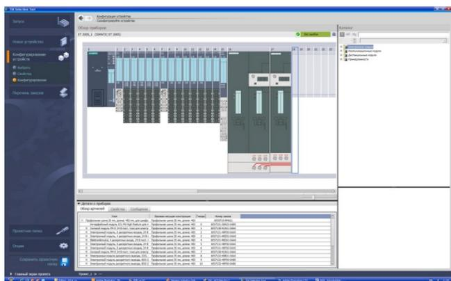
Для исключения ошибок при заказе станций ET 200S рекомендуется использовать программное обеспечение “TIA Selection Tool”, автоматически учитывающее все правила использования модулей и не позволяющее создавать неработоспособные конфигурации контроллера. Этот конфигуратор включен в электронный каталог CA01, интерактивную систему заказов “Industry Mall” и может быть найден в интернете по адресу: <http://www.siemens.com/tia-selection-tool/standalone>
