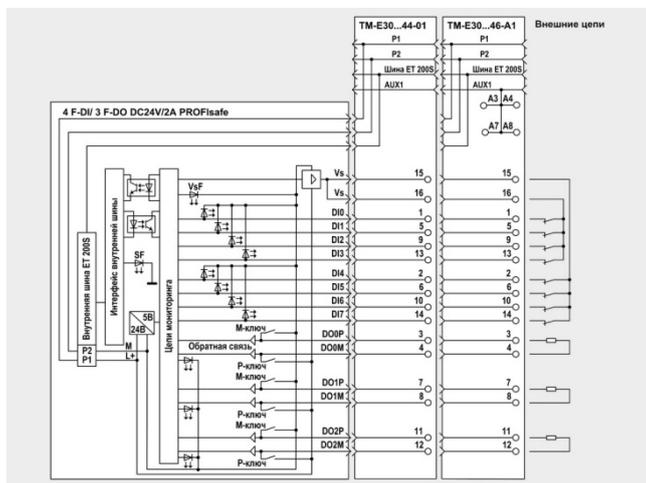
Модуль 4 F-DI/3 F-DO DC24V/2A PROFIsafe выпускается в пластиковом корпусе шириной 30 мм и комплектуется
