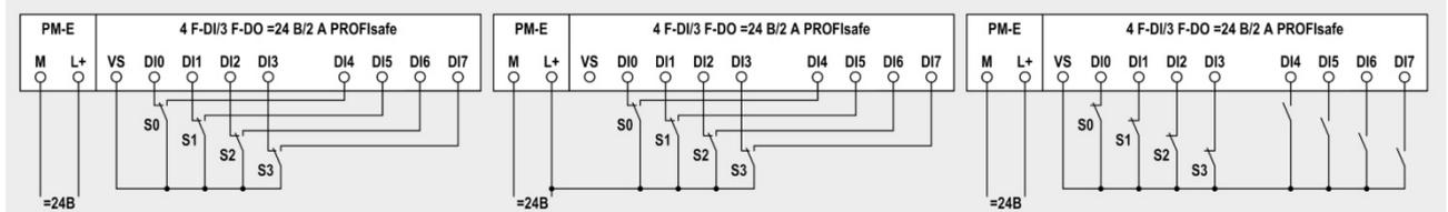
Схема 1.3: подключение датчиков с переключающими контактами или пар 1-канальных датчиков с размыкающим и замыкающим контактом
