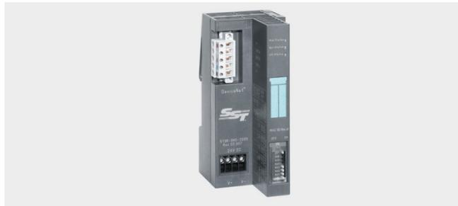
Модуль адаптера компании Molex (формально SST) для подключения станции ET 200S к сети DeviceNet. Он может использоваться с большинством модулей станции ET 200S, исключая модули PROFIsafe и силовые модули преобразователей частоты. Один интерфейсный модуль способен обслуживать до 63 модулей станции ET 200S.
