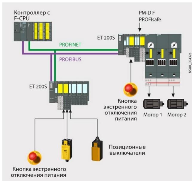
В станции ET 200S модули фидеров нагрузки F-DS1e-x и F-
