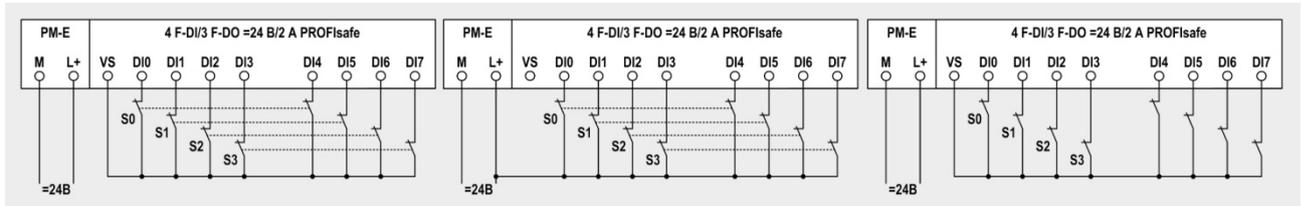
Схема 1.2: подключение 2-канальных датчиков или пар 1-канальных датчиков с размыкающими контактами
