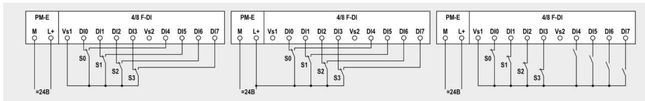
Схема 2.3: подключение датчиков с переключающими контактами и пар 1-канальных датчиков к 2-канальным входам
