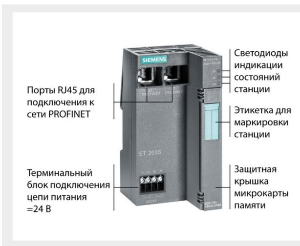
Все модули IM 151-3 PN монтируется непосредственно на профильную шину DIN и характеризуются следующими показателями:
