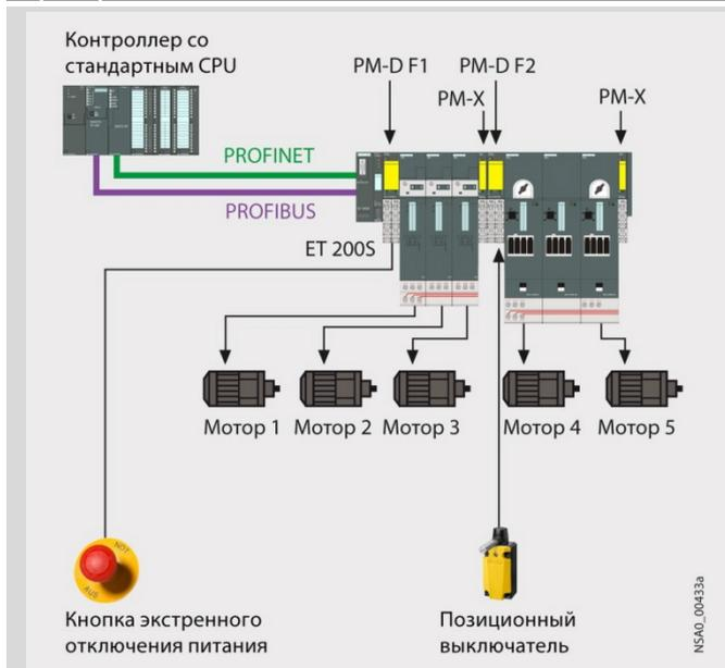
Система обеспечения безопасности на локальном уровне станции ET 200S с двумя отключаемыми группами. В одной из групп используются модули фидеров нагрузки DS1-x/ RS1-x, в другой DS1e-x HF/ RS1e-x HF.
